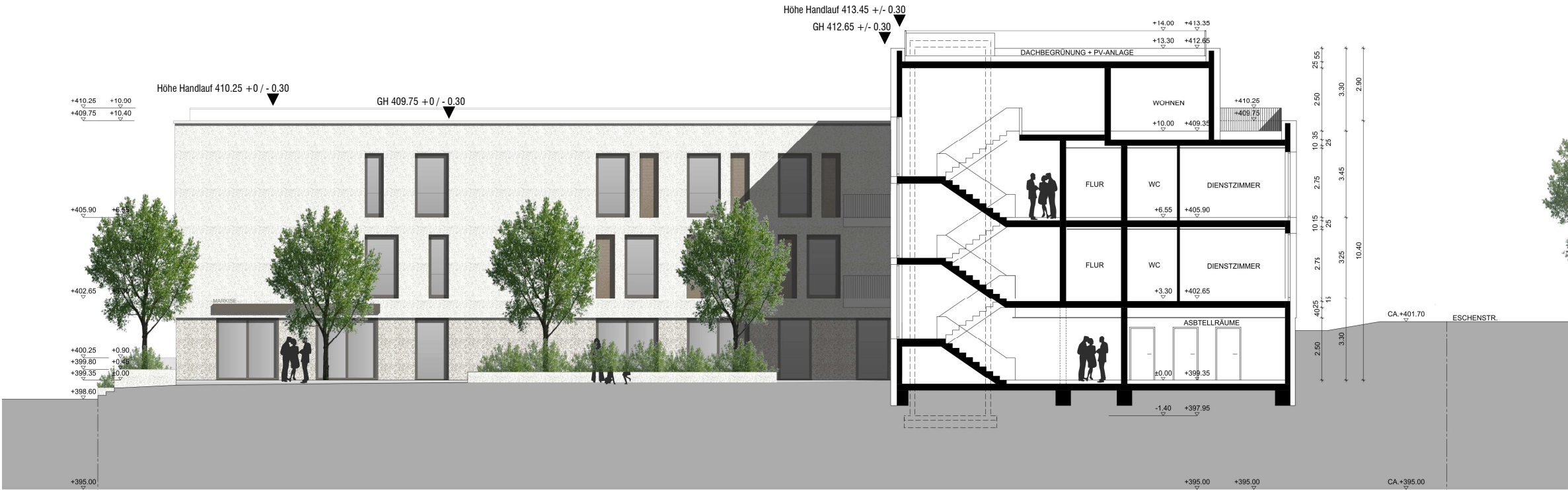
Schnitt CC / ANSICHT VON NORDOSTEN
